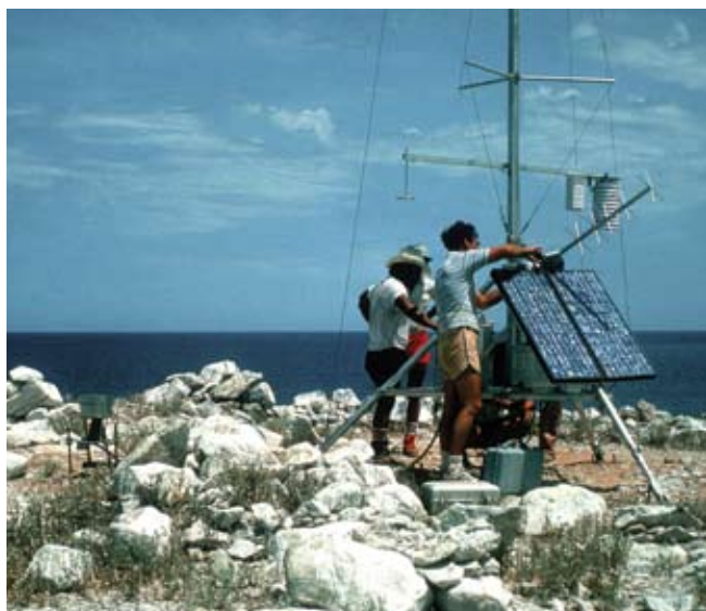
Station météorologique automatique portable dans la péninsule de Basse-Californie, au Mexique
