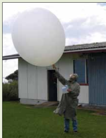
图B2.2: 释放一个装有无线电探空仪的氢气球—豪勋爵岛
